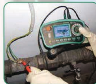
Continuity check of equipotential bonding
