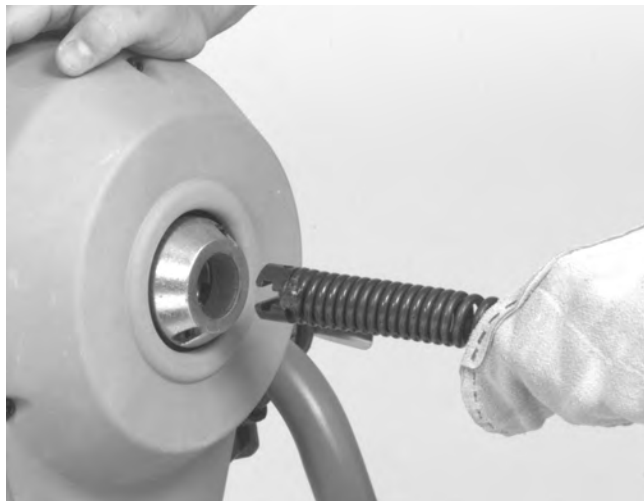
Figure 4 – Introduction du câble via l'avant du dégorgeoir
