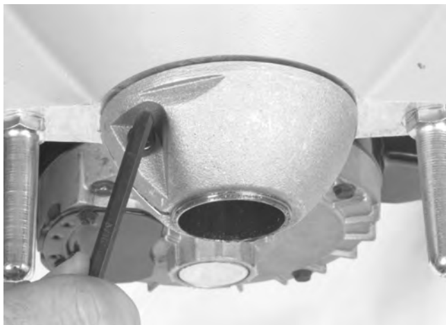
Figura 14 – Eliminación de la holgura del embrague
