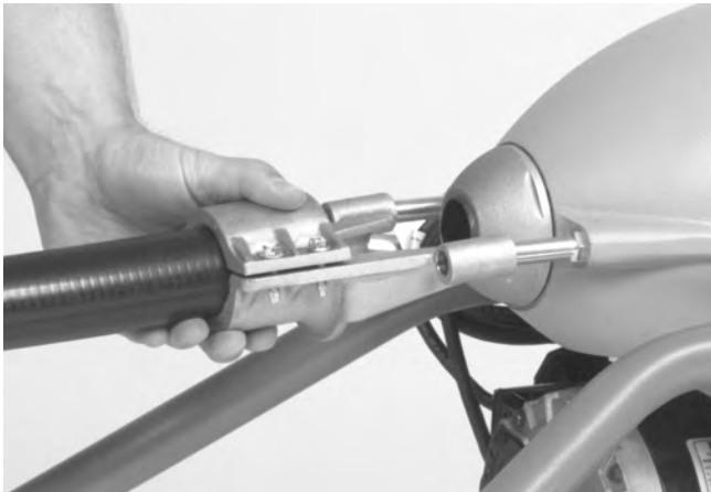
Figure 3 – Montage du guide-câble arrière
