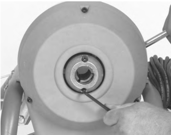
Figura 12 – Recambio de las mordazas del embrague
