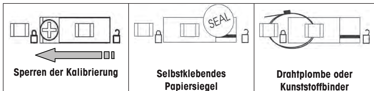
Abbildung 4-1. Sperren und Versiegeln des Kalibrierungssperrschalters.
