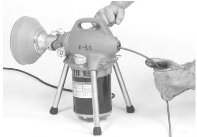
Figure 5 – Montage de l'adaptateur de câble
