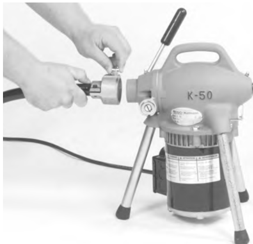
Figure 2 – Montage du guide-câble arrière
