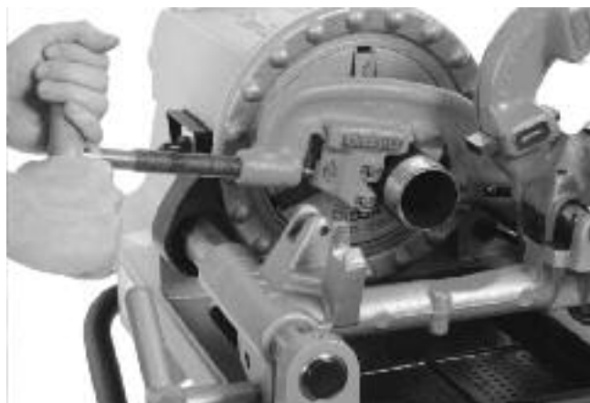
Figura 22 – Corte de un tubo con el cortador
