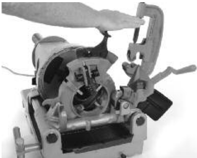
Figura 19 – Cierre del cabezal de terrajas con retroceso
