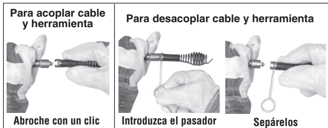
Figura 10 –Acoplamiento y desacoplamiento de herramientas en la punta del cable
