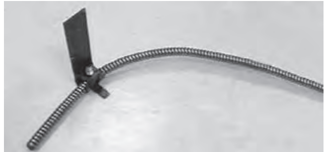
Figure 20 – Bras de levier attaché au câble. Le câble doit être coudé comme indiqué, avec la pince montée à environ 2 pouces de son extrémité
