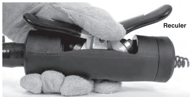
Figure 15 – AUTOFEED en positions « Avancer » et « Reculer »
