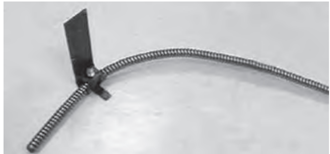
Figura 20 – Brazo torsor acoplado al cable a unas 2 pulgs de su extremo posterior. El cable ha sido curvado en 30°
