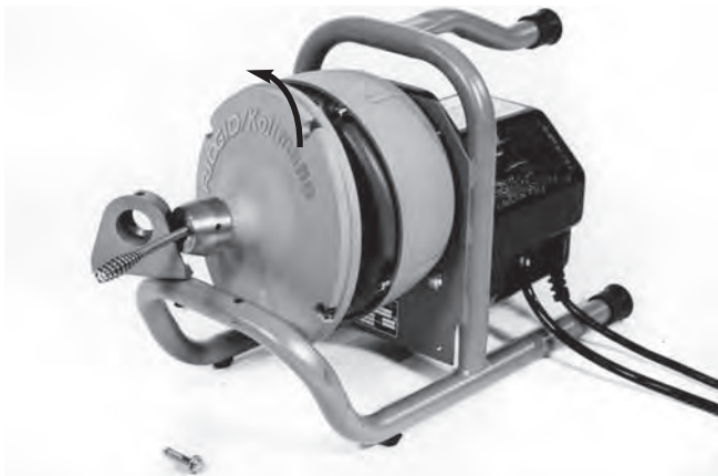
Figura 19 – Abra el tambor girando su tapa delantera hacia la izquierda
