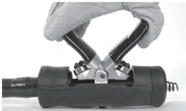
Figura 5 – Introducción del cable por el AUTOFEED
