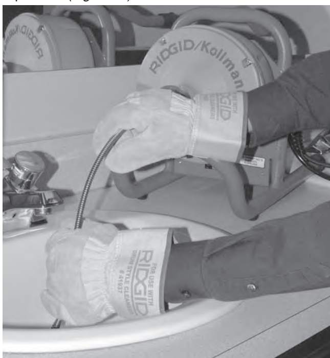
Figure 11 – Avancement manuel du câble
