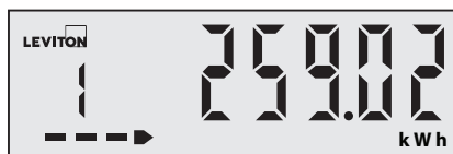
Figure 7 – Exemple d'écran en mode de fonctionnement normal
