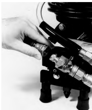
Figura 2 – Conecte la manguera de suministro de agua a la Limpiadora. Cierre la válvula de admisión del suministro (se la muestra en posición CERRADA)
