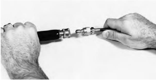
Figure 3 – Raccordement du flexible pression au dégorgoir
