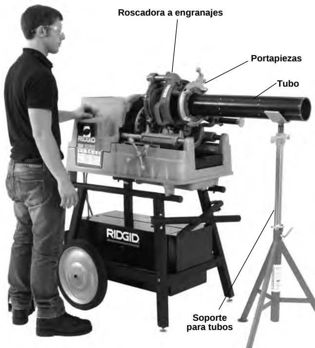
Figura 21 – Posición de operación (método de acoplamiento directo)
