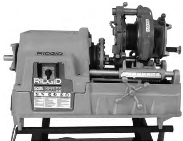
Figure 17 – Fileteuse démultipliée en montage direct avec 535
