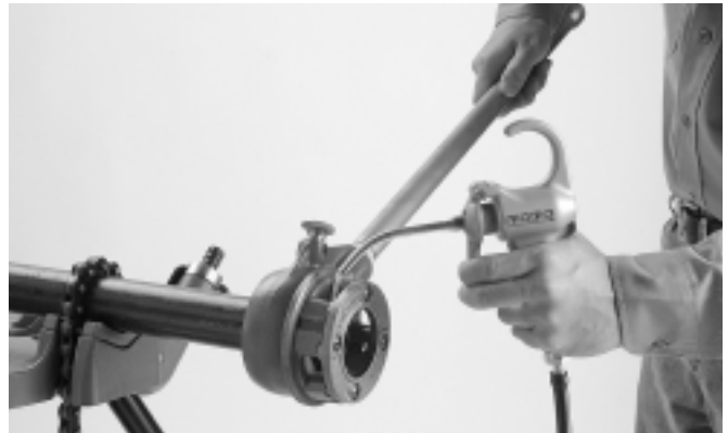
Figura 4 – Aceitado con aceite para cortar roscas
