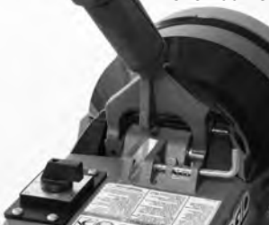
Figure 4 – Libération du levier d'embrayage
