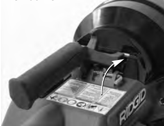
Figure 4 – Libération du levier d'embrayage
