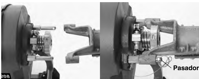
Figura 6 – Conexión de la manguera guía trasera
