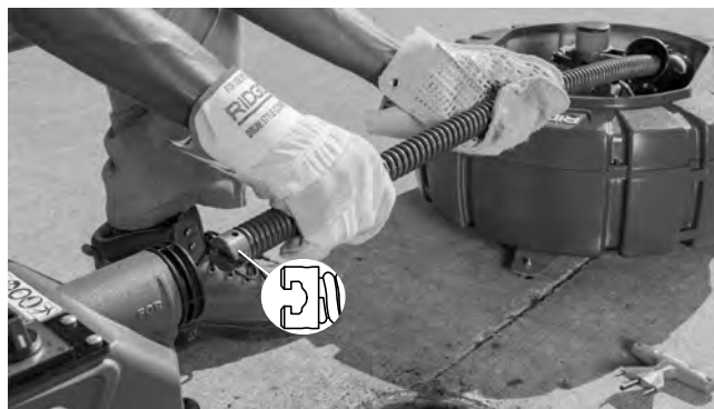
Figura 7 – Introducción del cable por el frente de la máquina
