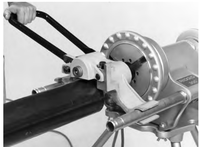
Figura 12 – Formación de una ranura a rodillo
