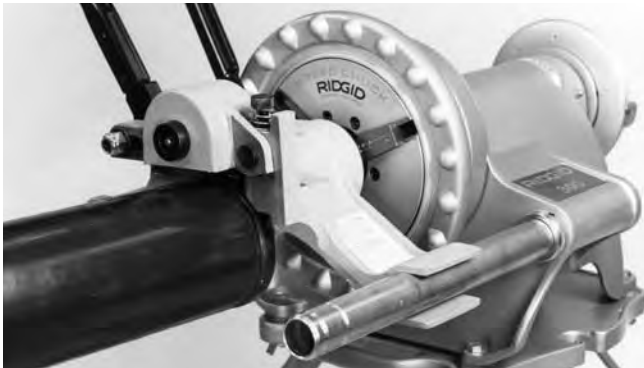
Figura 9 – Mango de alimentación en posición UP (arriba).
