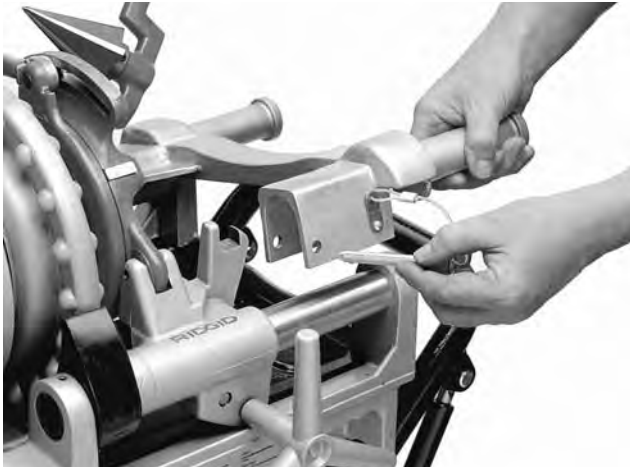
Figura 5 – Montaje del Caballete Adaptador a la Máquina Roscadora No. 300 Compacta
