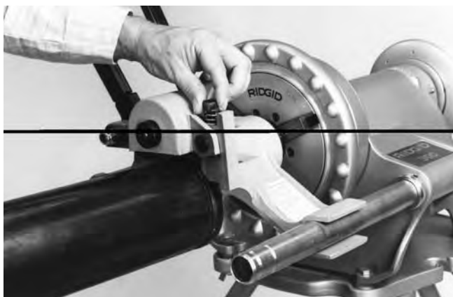
Figure 11 – Serrage de la vis de réglage de profondeur.
