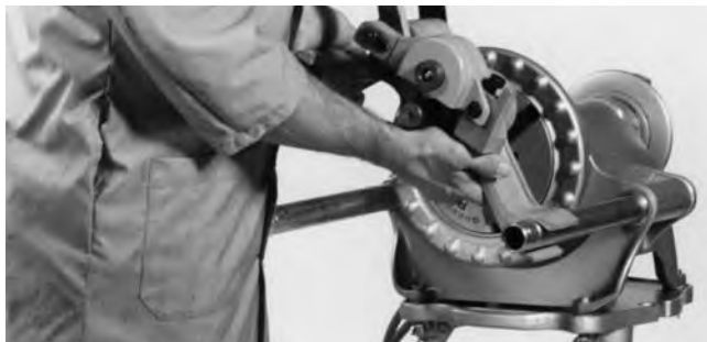
Figura 2 – Montaje sobre el Accionamiento motorizado No. 300
