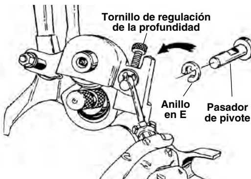
Figura 14 – Extraiga el anillo en E
