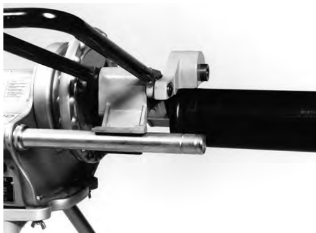
Figure 6 – Equerrage du tuyau et du porte-tubes
