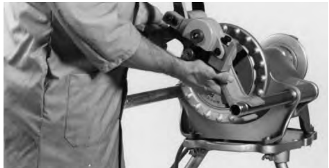
Figure 2 – Montage sur système d'entraînement n° 300
