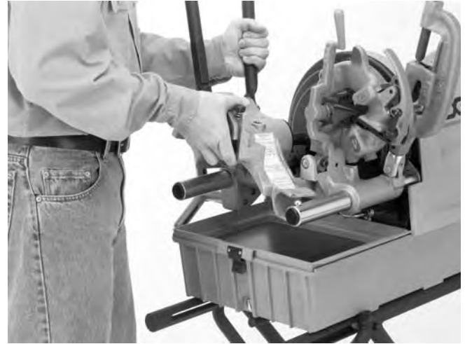
Figura 4 – Montaje sobre la Máquina Roscadora No. 1822-I (vale también para las máquinas roscadoras modelos 300 Compacta y 535)
