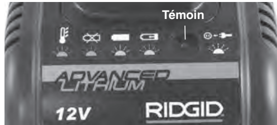
Figure 5 – Témoin LED et marquages du chargeur
