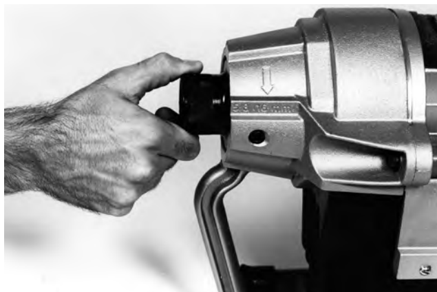
Figura 10 – Ajuste del conjunto de la mordaza
