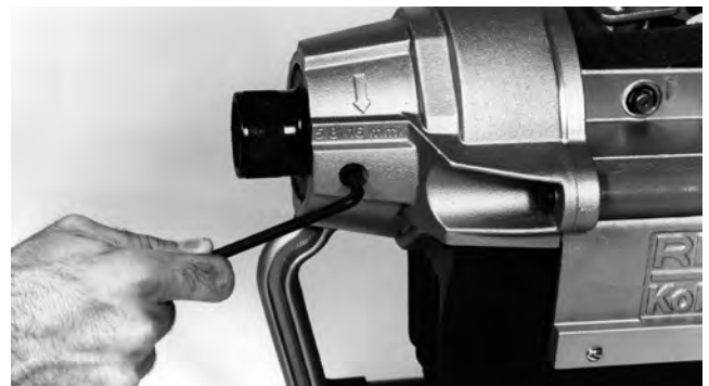
Figure 9 – Desserer la vis de blocage
