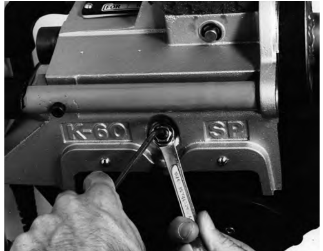
Figura 14 – Apriete la tuerca de inmovilización
