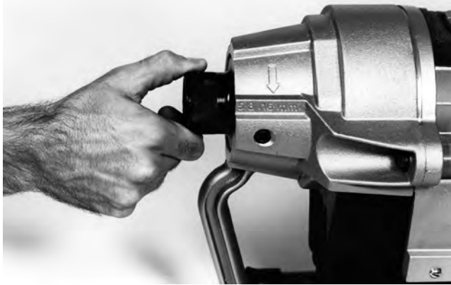
Figure 10 – Réglage des mâchoires
