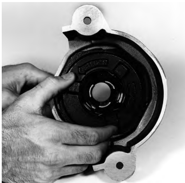
Figura 12 – Desmonte la tapa del juego de mordazas
