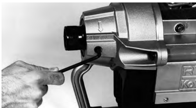
Figura 9 – Afloje el tornillo de retención
