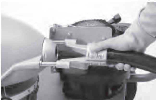
Figura 2 – Acoplamiento de la manguera guía trasera
