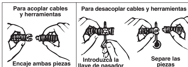
Figura 4 – Modo de acoplar y desacoplar cables y herramientas
