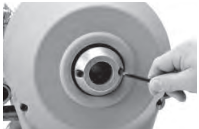
Figure 11 – Remplacement des mâchoires d'embrayage
