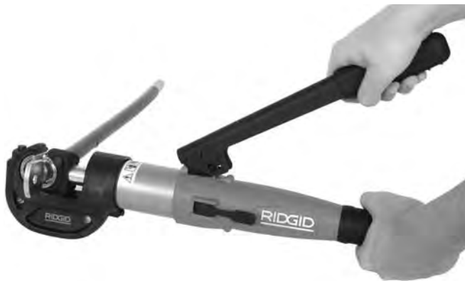
Figure 7 – Utilisation de la sertisseuse
