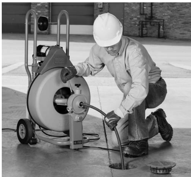
Figure 14 – Utilisation du K-750 avec AUTOFEED
