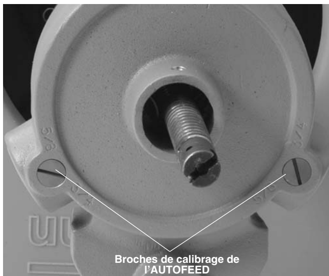
Figure 9 – Broches de calibrage de l'AUTOFEED
