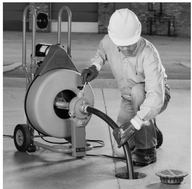
Figura 15 – Empleo de una limpiadora con manguera-guía delantera
