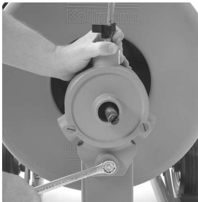
Figura 16 – Extracción del perno de la AUTOFEED
