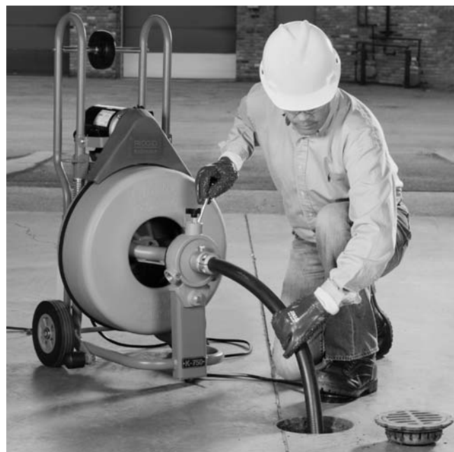
Figure 15 – Utilisation du dégorgeoir avec guide-câble
