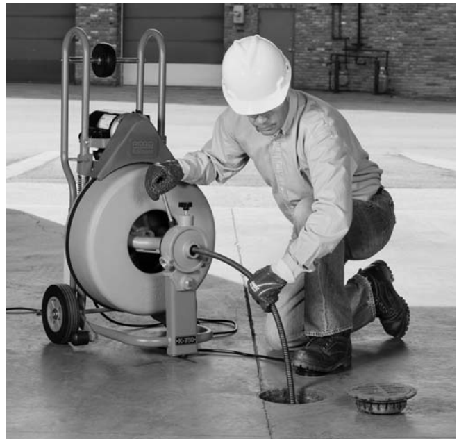
Figura 14 – K-750 con AUTOFEED en funcionamiento
