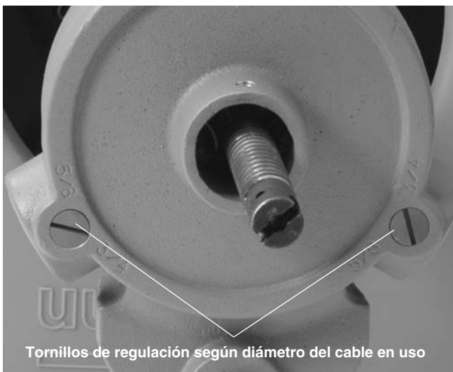
Figura 9 – Tornillos de regulación en la AUTOFEED
