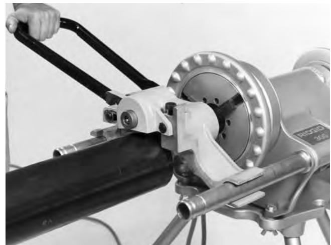
Figura 12 – Formación de una ranura a rodillo
