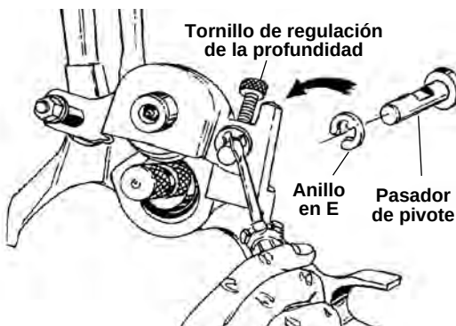
Figura 14 – Extraiga el anillo en E
