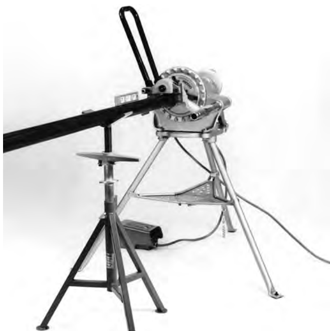
Figura 7 – Nivelación del tubo
