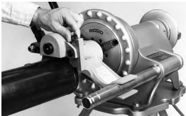
Figure 10 – Desserrage de la vis de réglage de profondeur
