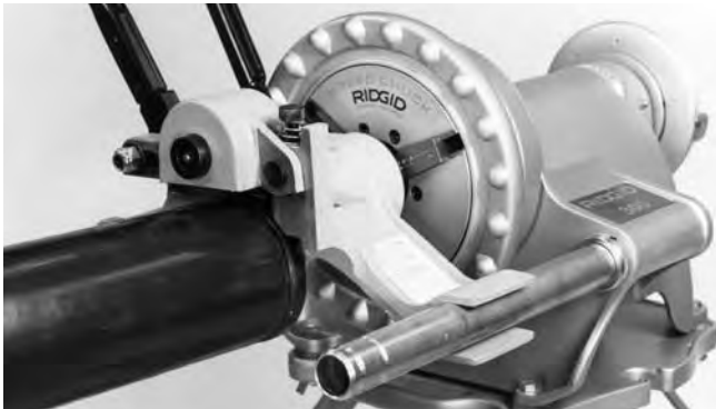
Figura 9 – Mango de alimentación en posición UP (arriba).
