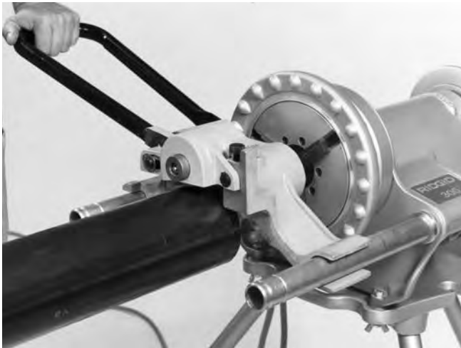
Figure 12 – Exécution du rainurage
