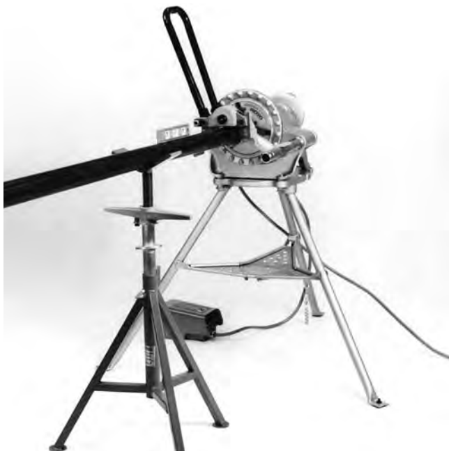
Figure 7 – Nivellement du tuyau.
