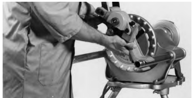
Figure 2 – Montage sur système d'entraînement n° 300
