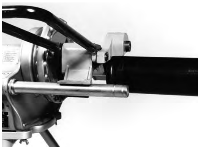
Figure 6 – Equerrage du tuyau et du porte-tubes
