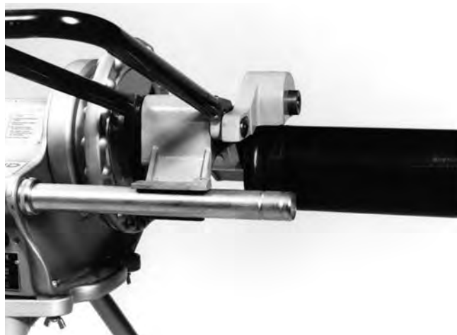
Figura 6 – Encuadre el tubo y el portatubos con relación a la Ranuradora
