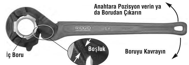
Şekil 2 – Karotiyer Anahtarı ile Çalışma
