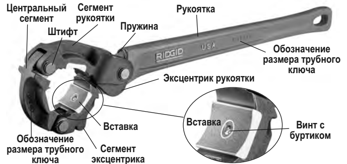
Рис. 1 – Колоночный трубный ключ
