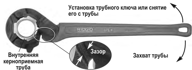
Рис. 2 – Работа с колоночным трубным ключом
