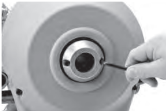
Figure 11 – Remplacement des mâchoires d'embrayage
