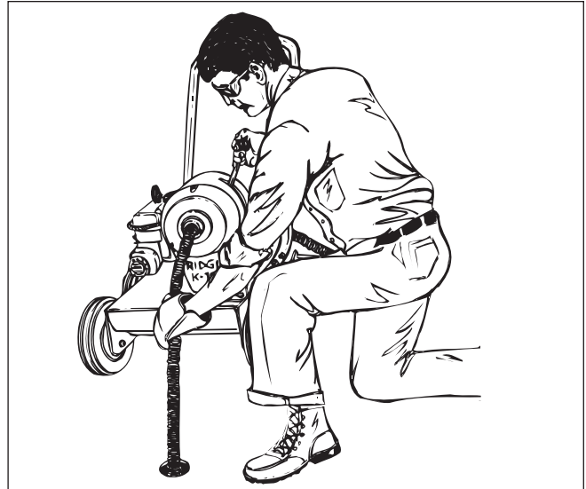
Figura 5 – Modo de empleo de la Limpiadora de Desagües
