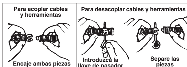
Figura 4 – Modo de acoplar y desacoplar cables y herramientas
