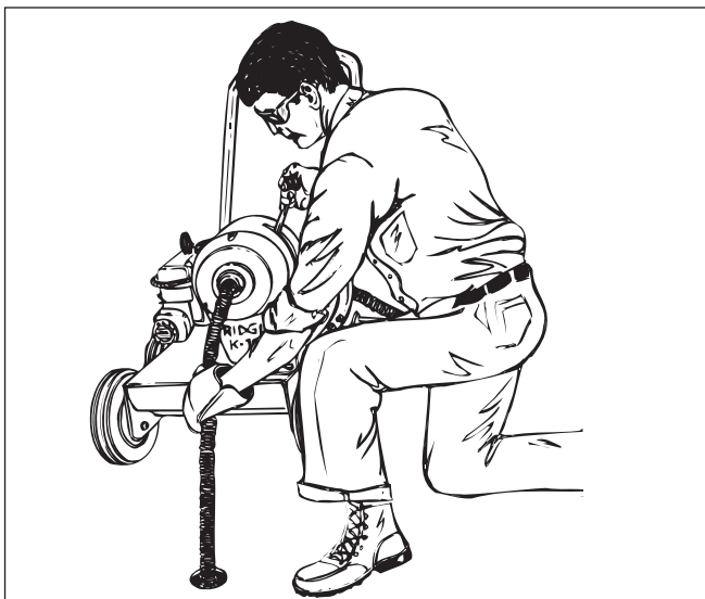
Figure 5 – Utilisation du dégorgeoir
