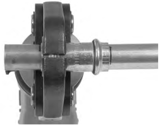
Figure 7 – RP 340 perpendiculaire au tube
