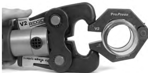
Figura 9 – Montaje del accionador en el aro sellador
