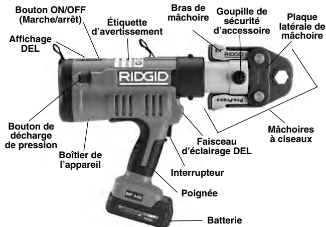
Figure 1 – Sertisseuse RP 340 et mâchoires
