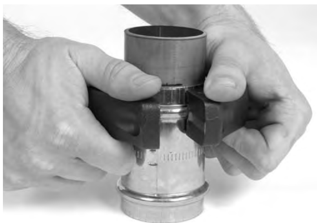
Figura 8 – Montaje del aro sellador en el acoplamiento
