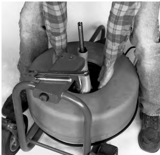
Figure 19 – Dépose du tambour
