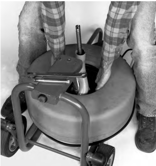
Figura 19 – Extracción del tambor
