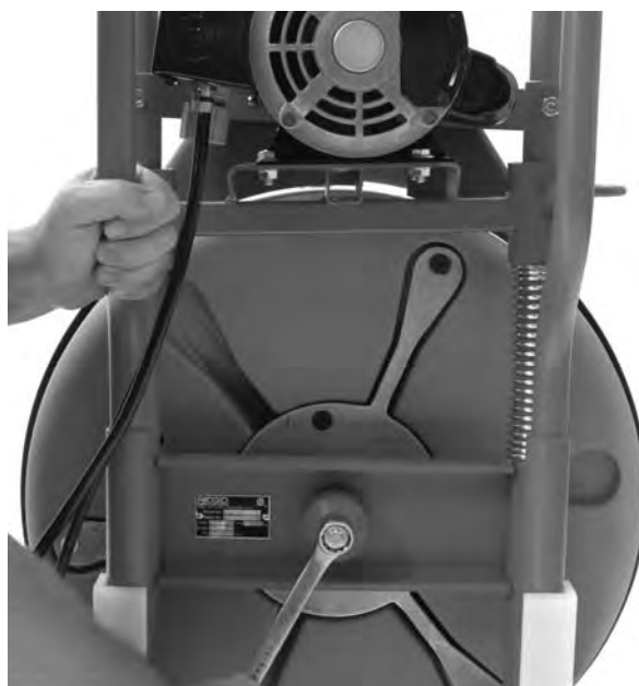
Figure 18 – Retrait du boulon du tambour
