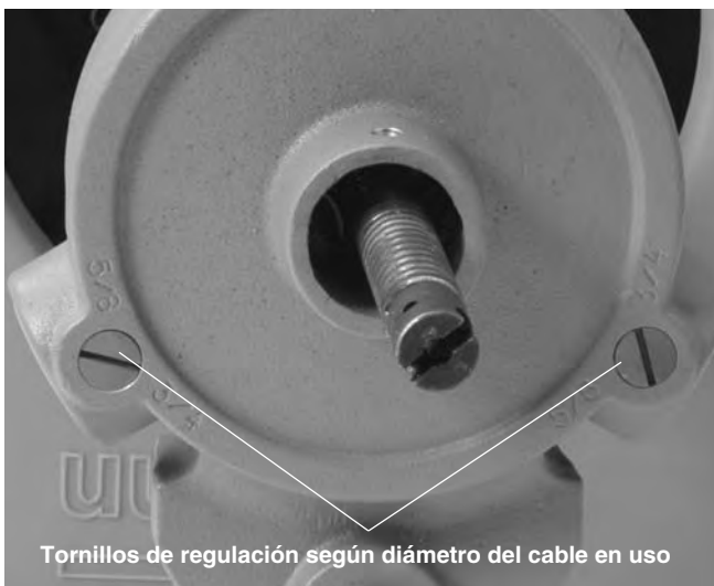
Figura 9 – Tornillos de regulación en la AUTOFEED
