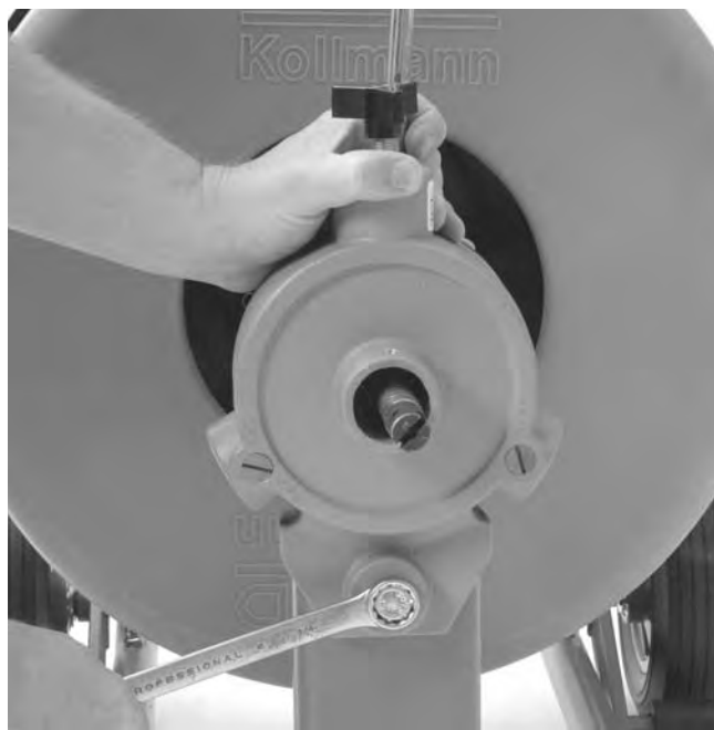
Figura 16 – Extracción del perno de la AUTOFEED
