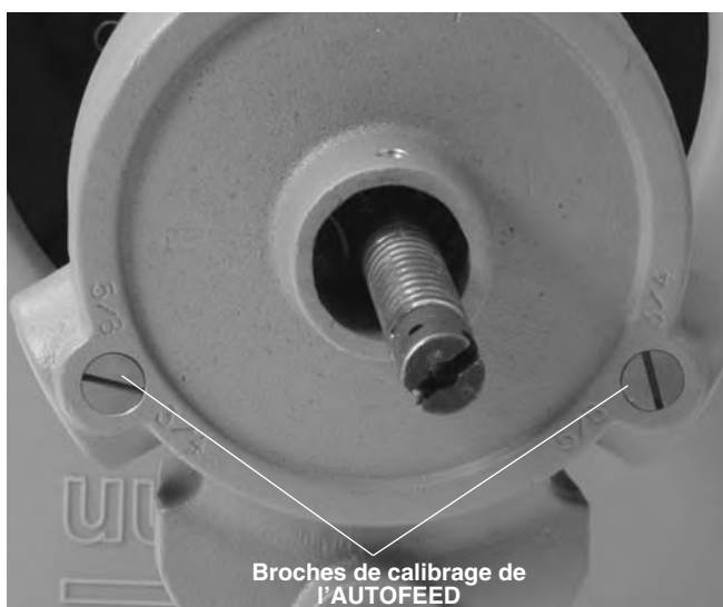
Figure 9 – Broches de calibrage de l'AUTOFEED
