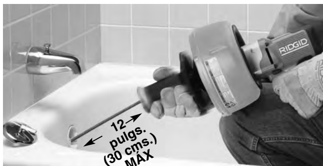
Figura 8 – Mueva la empuñadura hacia atrás para enganchar el cable con el portabrocas
