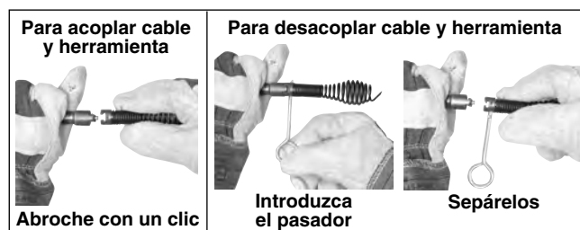
Figura 7 – Acoplamiento y desacoplamiento de herramientas en la punta del cable
