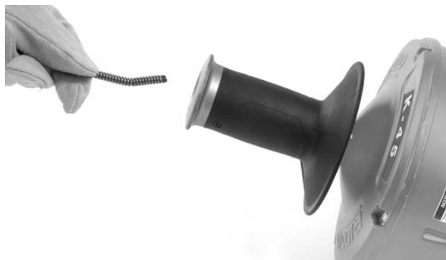
Figure 17 – Chargement du câble sans remplacer le tambour interne
