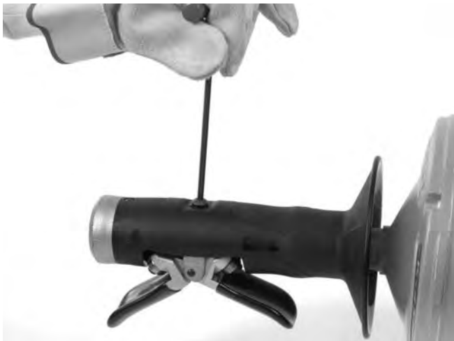
Figure 12A – Retrait de la vis de l'AUTOFEED
