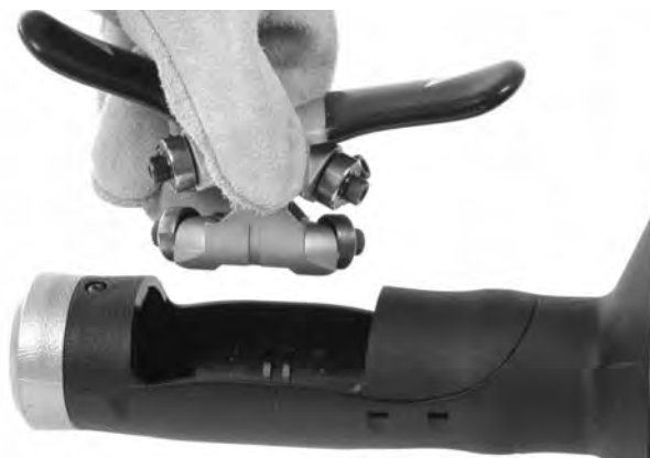
Figura 12B – Extracción del mecanismo de la AUTOFEED
