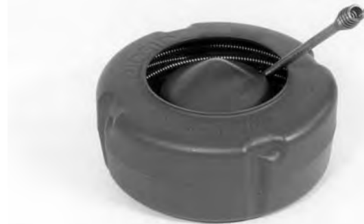
Figura 16 – Enrolle el cable dentro del tambor interior en el sentido de las manecillas del reloj
