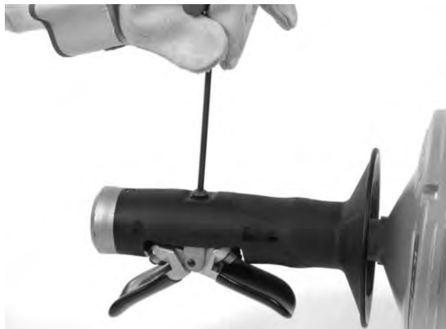
Figura 12A – Extracción del tornillo de la AUTOFEED
