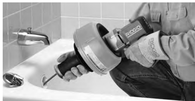
Figure 9 – Pousser le câble dans la conduite
