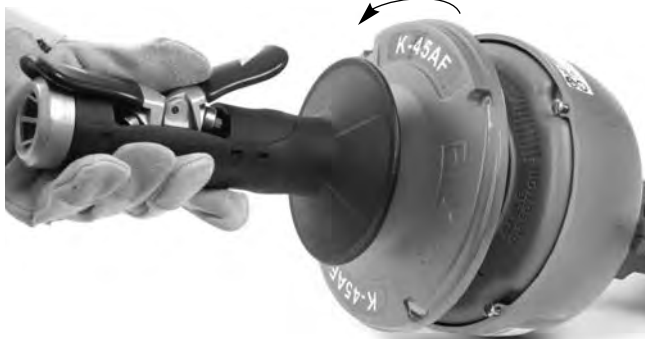
Figura 14 – Apertura de la tapa del tambor exterior
