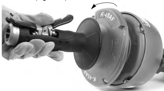
Figure 14 – Ouverture du tambour
