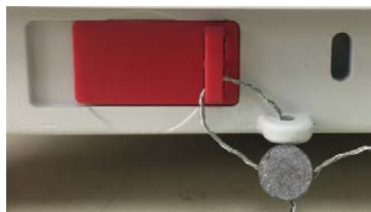
Bloccato con Sigillo di Cavo
