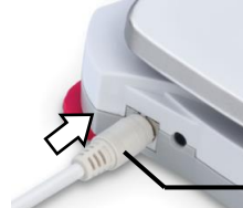
ミニ DIN ポート (丸型コネクタ)
