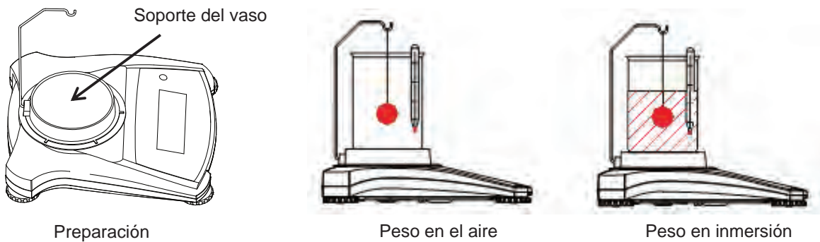
Gráfico 3-3. Configuración para la medición de densidad
