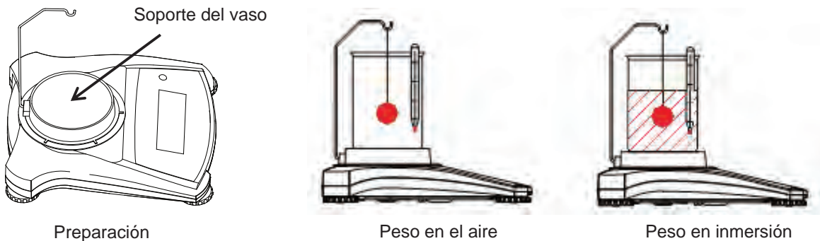
Gráfico 3-3. Configuración para la medición de densidad
