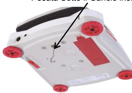
Pesata Sotto il Gancio installato
