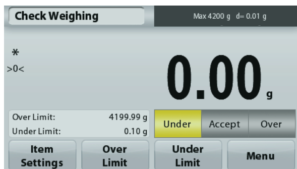
Schermata iniziale del Controllo Peso
