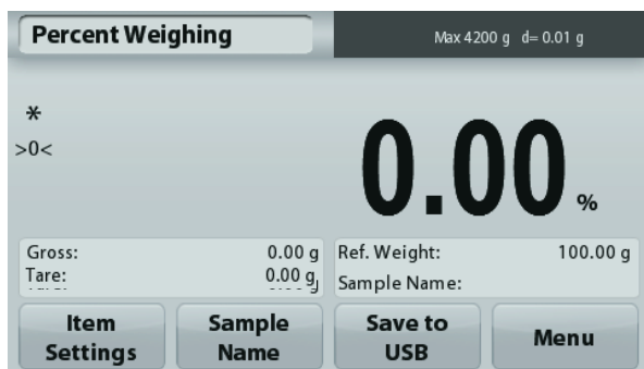
Schermata iniziale della Pesatura percentuale
