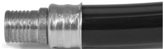
Figura 3 – Acoplamiento engarzado correctamente
