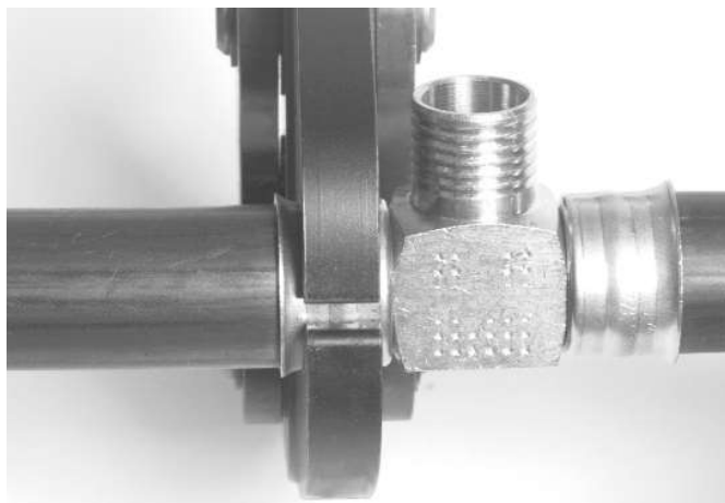
Figure 2 – Positionnement des mâchoires à ciseaux sur le raccord PureFlow®
